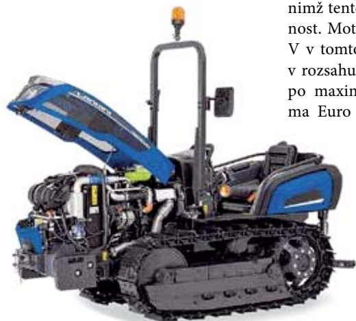
Landini Trekker 3 má super kompaktní motor KOHLER KDI 2504 STAGE V má obsah 2,5 l
