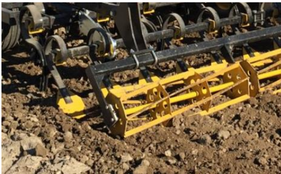
Obrázek 2: AVARAN se zadní hydraulickou lištou + prutový válec
