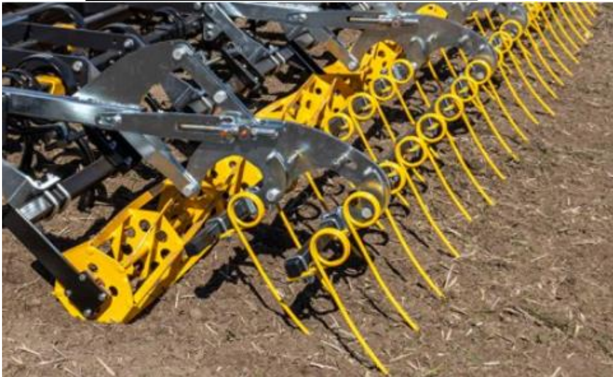
Obrázek 3: Zadní prutový válec a dvouprsté zavlačovače
