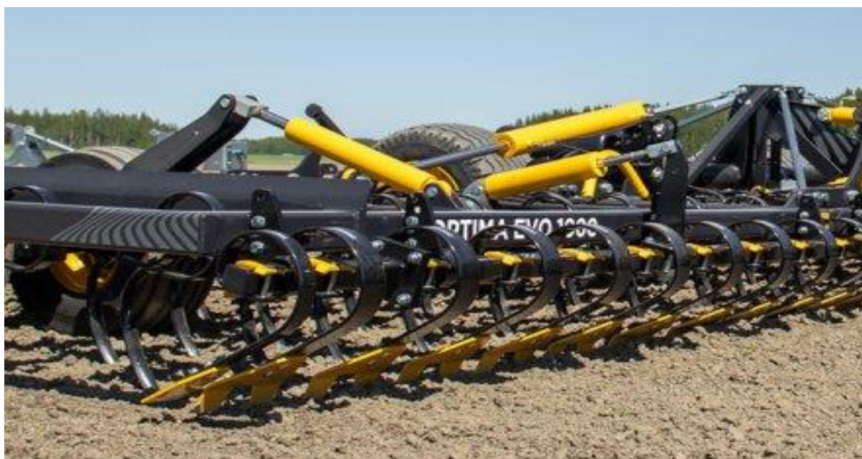
Obrázek 2: Přední hydraulicky stavitelná smyková lišta
